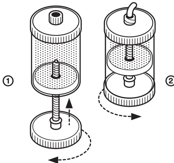
**Achtung!** Wird der verschiebbare Boden versehentlich durchbrochen oder die Spindel dauerhaft im Gefäßboden arretiert, kann die Kruke nur noch als Abgabe- bzw. Aufbewahrungsgefäß dienen, jedoch nicht mehr für den Rührvorgang genutzt werden.
